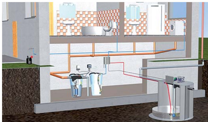
Obr. 4: Schéma využití srážkových a šedých vod v RD [4], [9]
