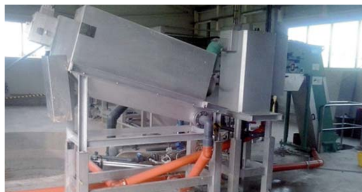
Obr. 2: AS-DEHYDRÁTOR používaný k odvodnění vyprodukovaného kalu
